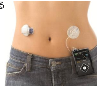
【インスリンポンプ（SAP）】 リアルタイムCGMを併用したインスリンポンプ療法。低血糖傾向を感知して注入を一時停止する機能あり
