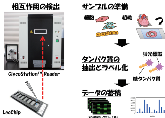
図3 レクチンマイクロアレイ法による糖鎖解析の流れ。細胞や組織から抽出したタンパク質を蛍光標識し、レクチンとの相互作用から糖鎖構造を網羅的に調べる。
